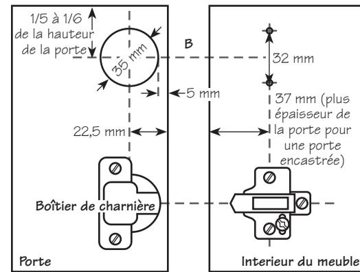
La plaque de montage peut maintenant être posée fente vers l'avant. Posez la porte en glissant le bras de la charnière dans la plaque de montage, serrez la vis et procédez aux réglages.
