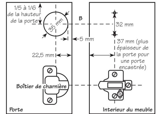
La plaque de montage peut maintenant être posée fente vers l'avant. Posez la porte en glissant le bras de la charnière dans la plaque de montage, serrez la vis et procédez aux réglages.
